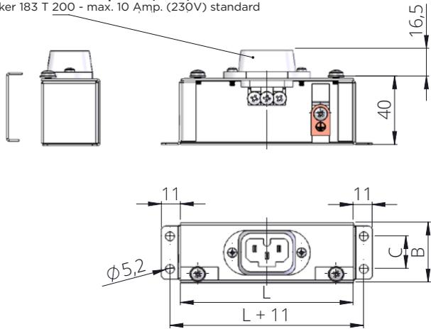
Casing without terminal strip / Gehäuse ohne Klemmschienen
